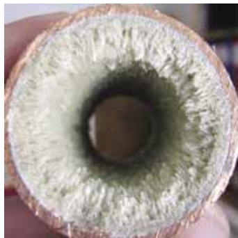
Käyttövesiputkiin kertynyttä kalkki- ja ruostekerrostumaa.
