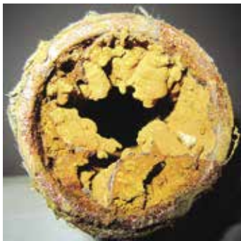
Käyttövesiputkiin kertynyttä kalkki- ja ruostekerrostumaa.
