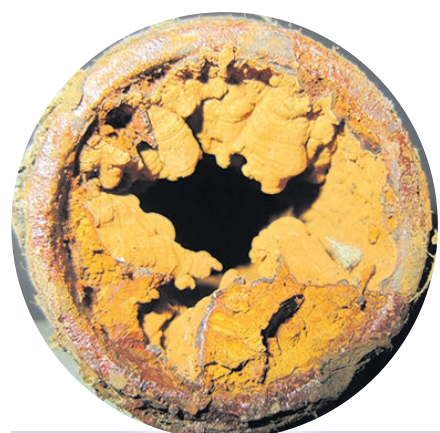
Kalkki- ja ruostekerrostumaa kylmävesiputkessa.
