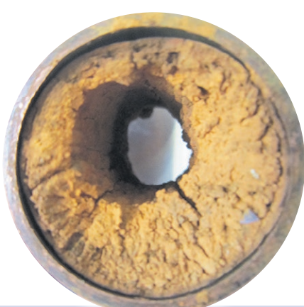
Kalkki- ja ruostekerrostumaa kylmävesiputkessa.
